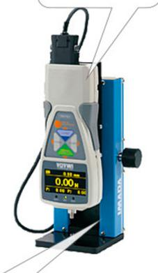
Stativo manuale modello MS-50N, compatto e facile da trasportare, equipaggiato con encoder ottico dgitale per la misura dello spostamento nella versione FSA-MSL
